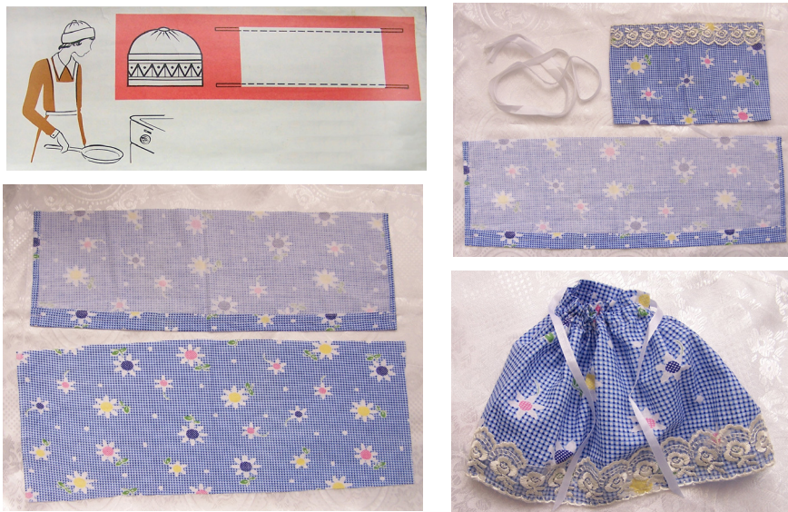
Расми 72. Коркарди каллапӯш: а) дӯхтани кӯкҳои дастӣ; б) дӯхтани дарзи мошинӣ; пайваст қардани шерокаи оройишӣ; в) пурра дӯхтани каллапӯш
